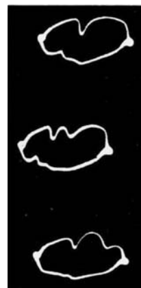
Abb. 1 Derivative Oszillogramme nach der Methode von Heyrovský-Forejt 11) von o-, m- und p-Nitrophenol in 1 n KOH. Abszisse: Spannung V; Ordinate: \frac{dV}{dt} Nach Heyrovský 15)
